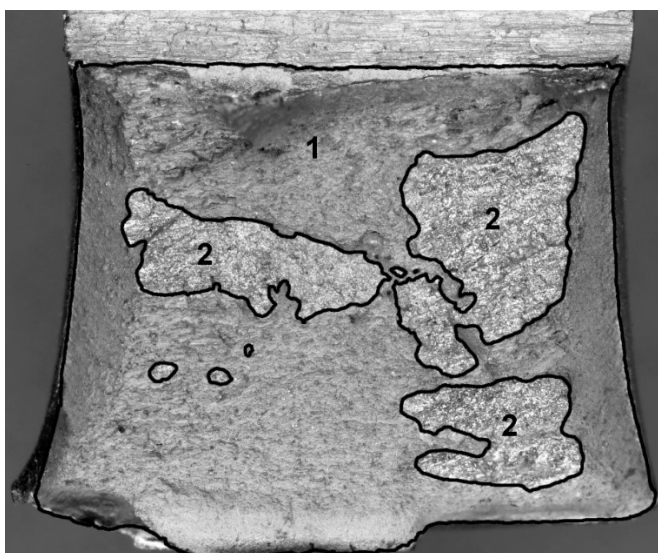
Рисунок 3.1 – Излом образца сварного соединения с выделенными областями. 1 – вязкая область, 2 – хрупкие участки
