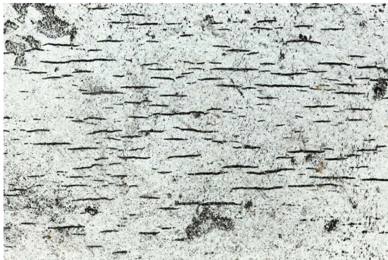
Рисунок 2.8 – Общий вид колонии трещин КРН после магнитно-порошковой дефектоскопии.
